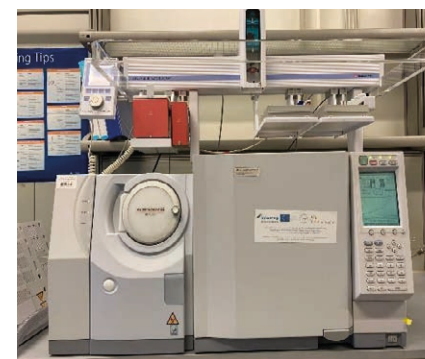
Chromatografia gazowa sprzężona ze spektrometrem mas (GC/MS QP2010SE)
