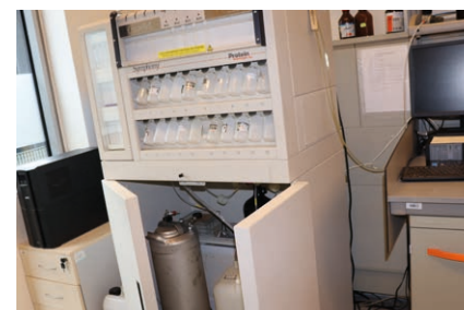
Automatyczny syntetyzator peptydów Quartet, Gyros Protein Technology, Inc., USA
