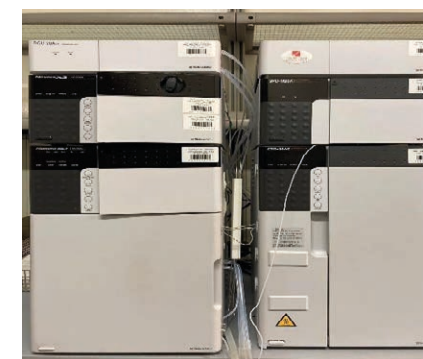
Ultrasprawa chromatografia cieczowa UPLC z detekcją kaskady diod (Shimadzu Nexera X2 DAD)
