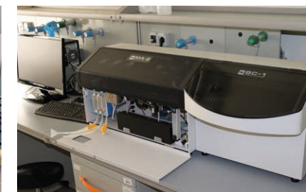
Analizator rtęci MA-2 z automatycznym podajnikiem próbek BC-1 (Nippon)
